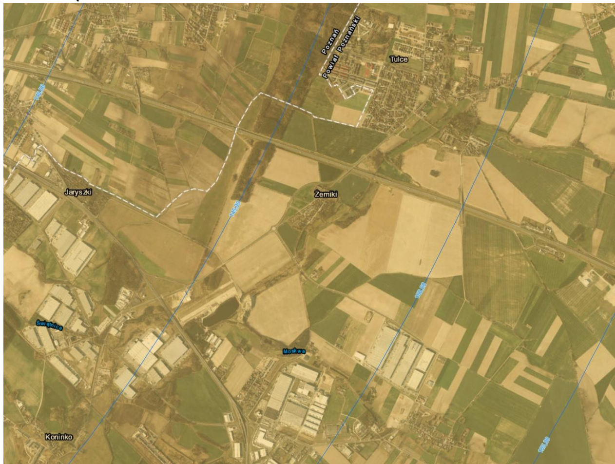
Ryc. 24 Lokalizacja strefy powierzchni ograniczającej zabudowę (BRA) dla lotniczych urządzeń naziemnych (LUN) nakaz ograniczenia wysokości obiektów budowlanych wraz z umieszczonymi na nich urządzeniami
