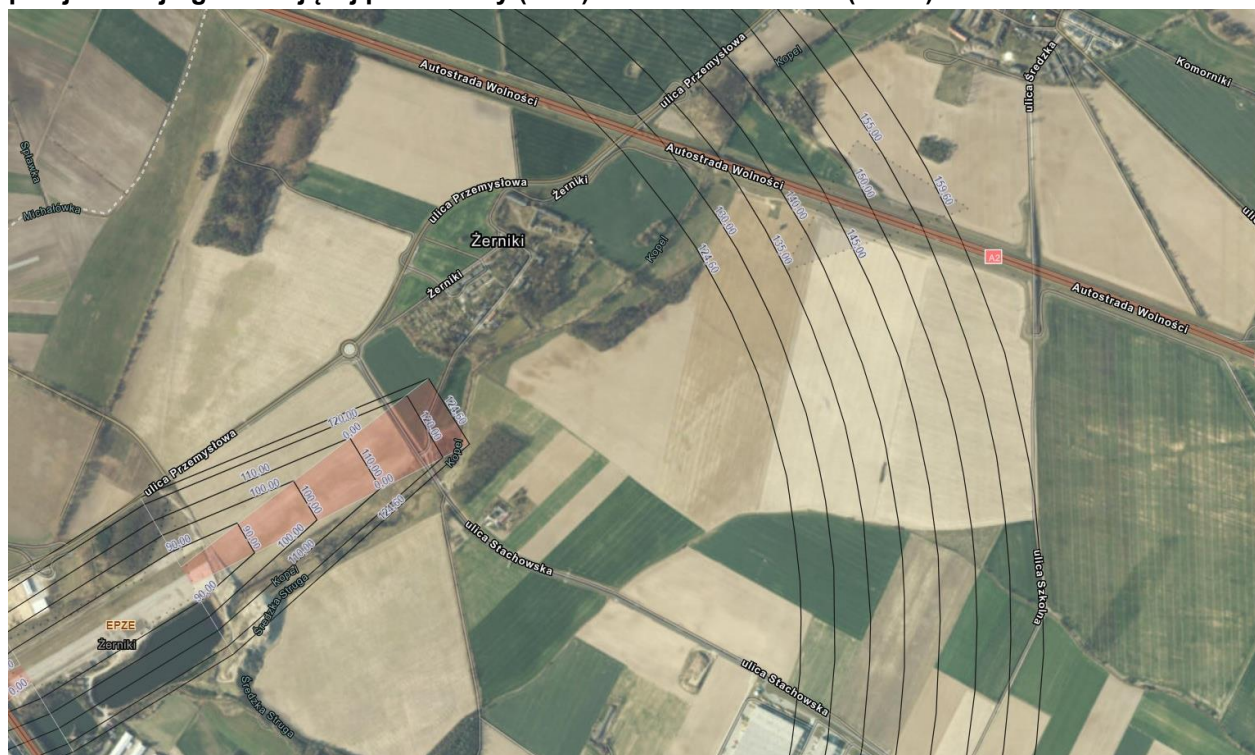
Ryc. 23 Strefy powierzchni podejścia ograniczającej przeszkodę (OLS) oraz strefy powierzchni przejściowej ograniczającej przeszkodę (OLS) dla lotniska Żerniki (EPZE)
